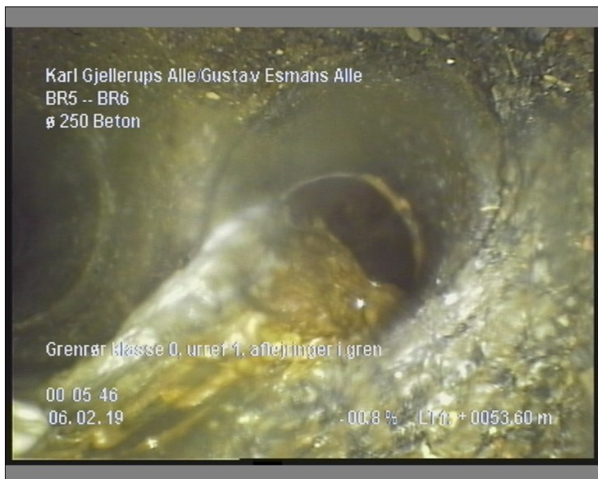
Foto: 6_14A, Medie #: LY19.9007, 00:05:47 53,6m, Grenrør klasse 0, urref 1
